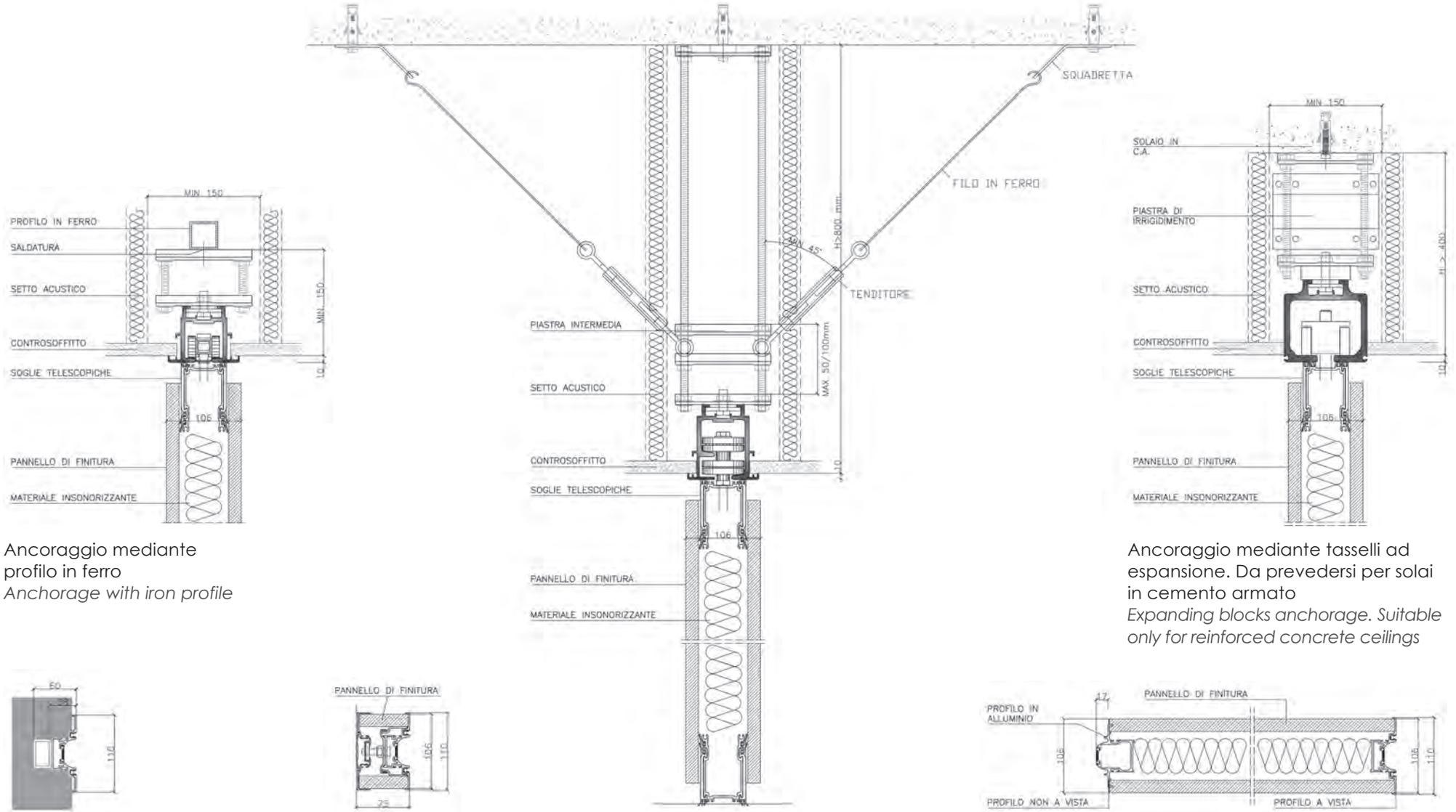
Ancoraggio mediante profilo in ferro
